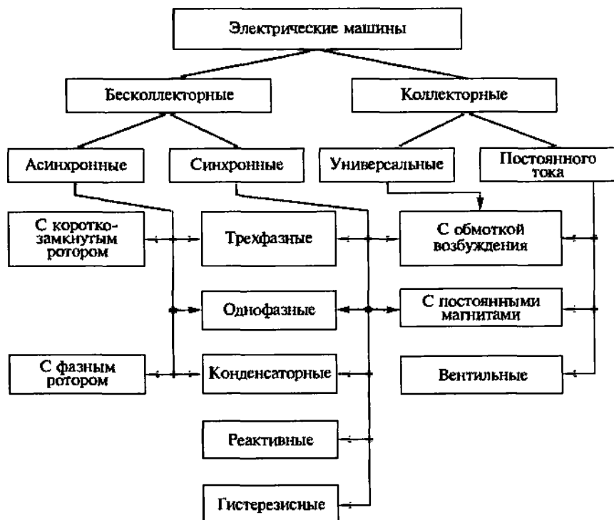
Рис. 1.2. Классификация электрических машин
